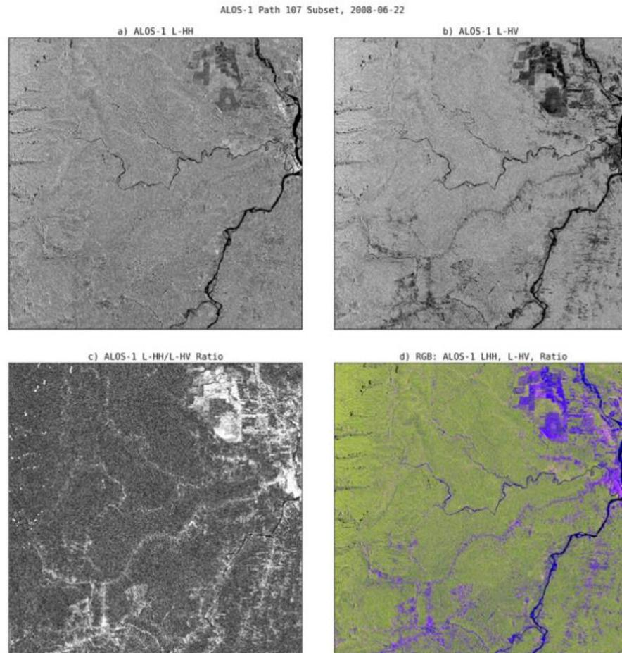
ALOS-1 L-band images: (a) L-HH, (b) L-HV, (c) ratio, and (d) RGB composite LHH/LHV/ratio (22/06/2008).
