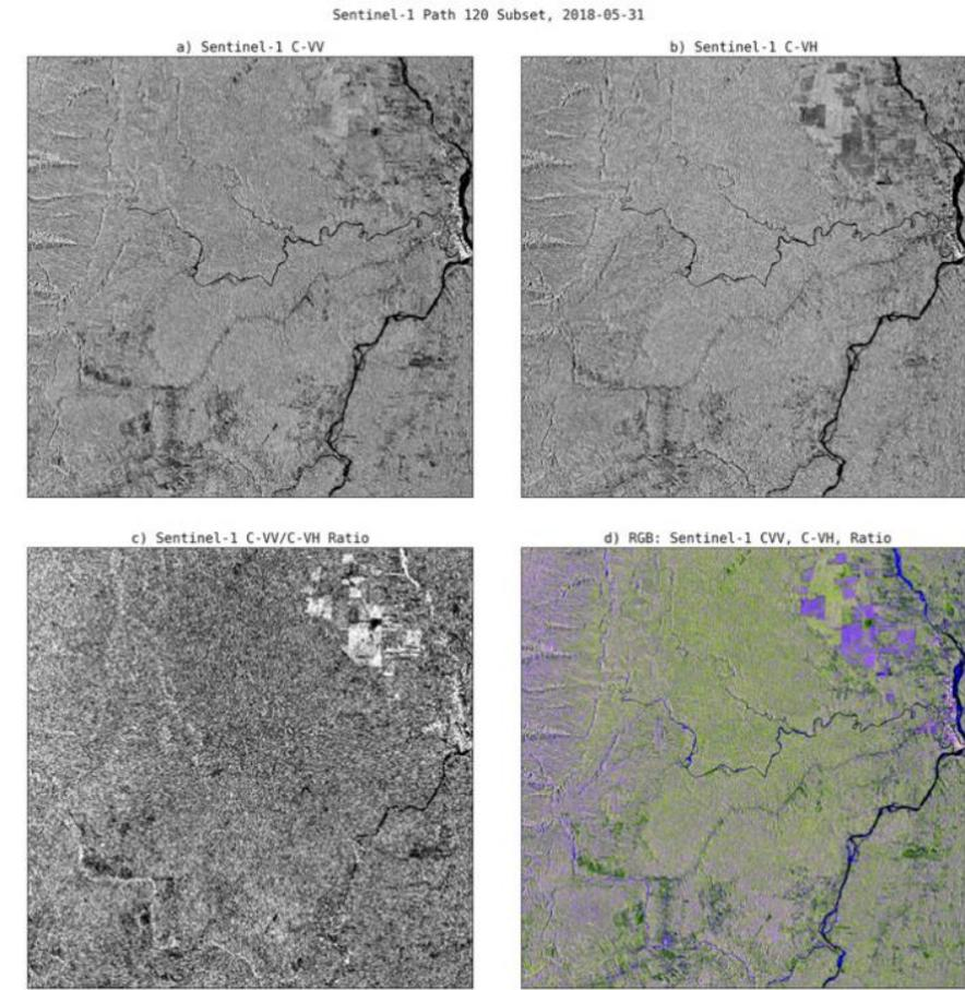
Sentinel-1 C-band images: (a) C-VV, (b) C-VH, (c) ratio, and (d) RGB composite CVV/CVH/ratio (31/05/2018)
