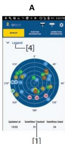
L'onglet **A** permet de vérifier la réception des satellites et l'onglet **B** vous indique la qualité du positionnement (c'est la HRMS qui nous intéresse : normalement, elle doit se stabiliser à moins de 50 cm). Attendez quelques minutes.
